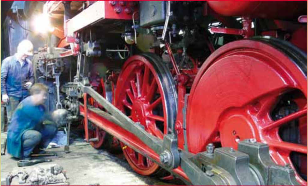
▲ ...ebenso wie beispielsweise bei der Wiederinbetriebnahme einer Museumslokomotive. Hier wird mit vereinten Kräften bei der Lok 50 2740 das Gestänge des Triebwerks montiert.
